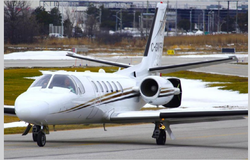
Thrust Reverser an einer Cessna Citation 550. Das System wird zumindest bei den leichteren Jets um 5,7 Tonnen meist nicht mehr verbaut. Bild: Airport Action
