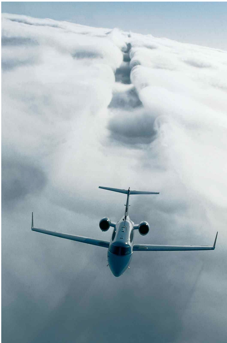
Ein Learjet des Irish Air Corps hinterlässt einen Graben in den Wolken hinter sich. Hier kann man ohne Windkanal sehen, dass der Auftrieb durch die Umlenkung der Luft nach unten entsteht. Foto: Irish Defence Forces
