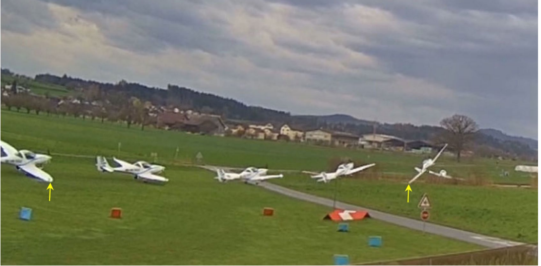
Eine Aquila wird erst 50 Meter nach Bahnende auf der Rückseite der Power-Kurve in die Luft gezwungen, stallt und stürzt ab. Gelbe Pfeile: Bodenberührung der Tragfläche Montage aus Videosequenz, SUST
