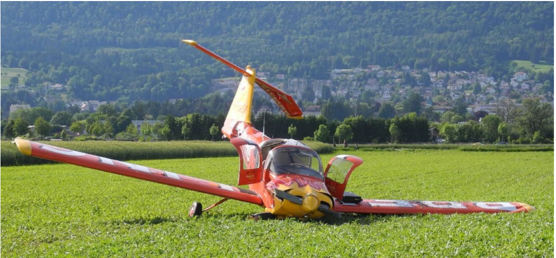
Ende eines Schulungsflugs mit einer Piper Tomahawk in Grenchen. Es gelang nicht, das Flugzeug im Bodeneffekt zu beschleunigen. SUST Schlussbericht
