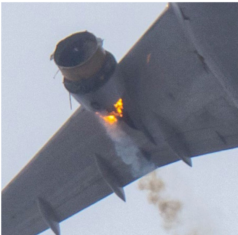
Ein Foto vom Boden aus aufgenommen: Drei Minuten nach dem Triebwerksausfall brennt das Triebwerk immer noch. (NTSB Timeline)
