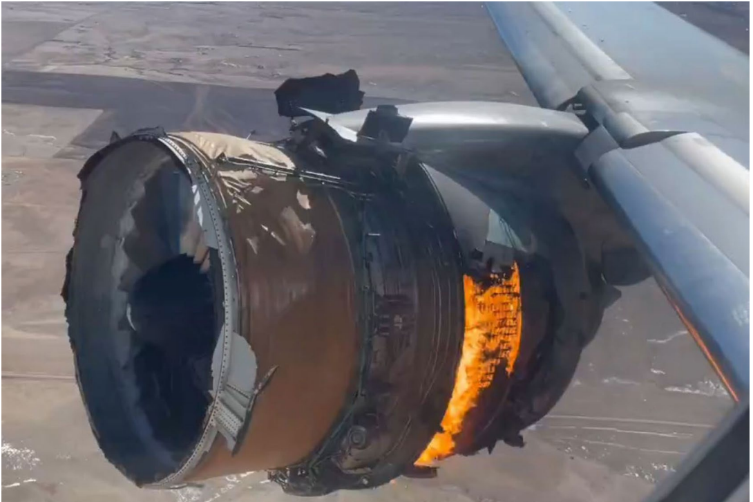
FBO + 11 Minuten (FBO = Fan Blade Out). Kurz danach erlosch im Cockpit die Fire Warnung – aber nicht das Feuer ...
