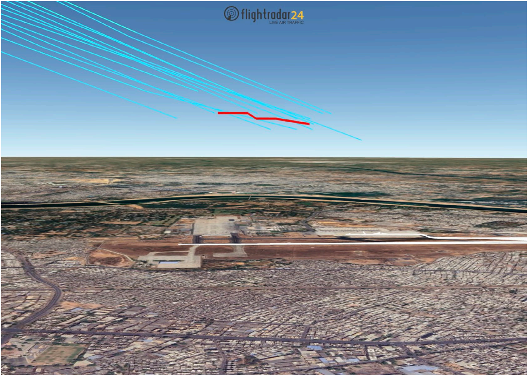
Der Flugweg der Air India 171 (rot), hier schon abgeflacht, inmitten der Flugwege der anderen Abflüge nach Gatwick im Monat vor dem Unfall (zwei davon von derselben Maschine). Die unkalibrierten ADS-B Daten zeigen, dass bis zum Ausfall der Triebwerke der Start ähnlich den anderen Abflügen abgelaufen sein muss. Flightradar24
