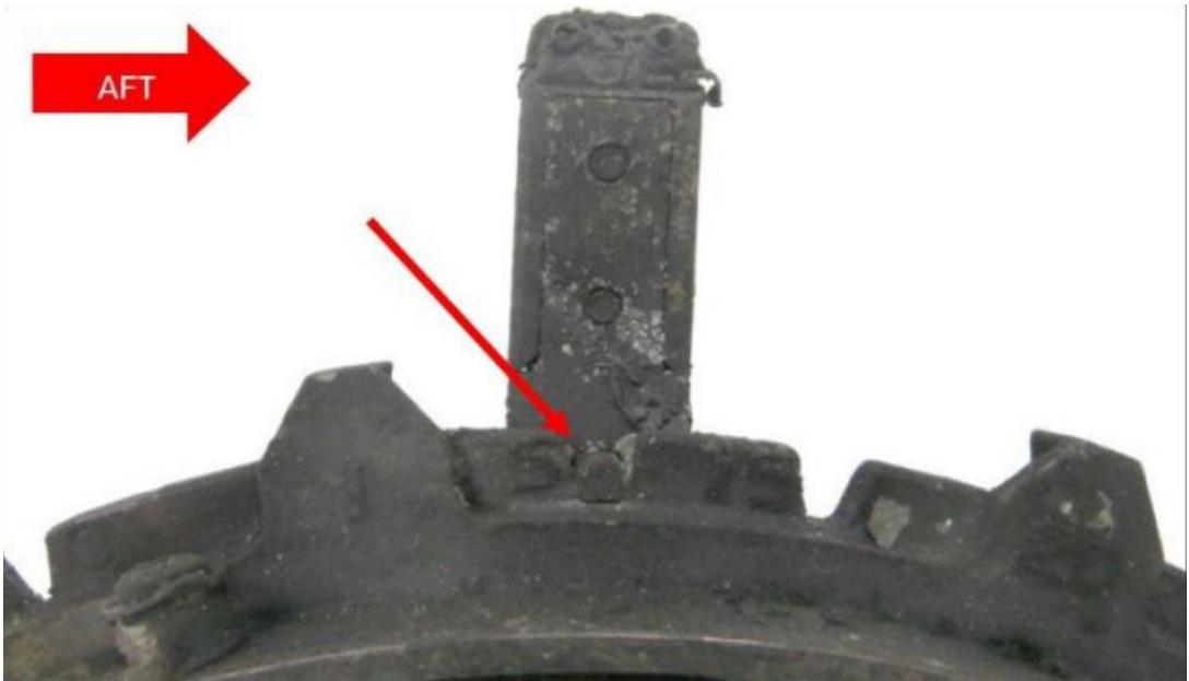
Der Klappenhebel wurde in der FLAPS 5 Raste vorgefunden.
