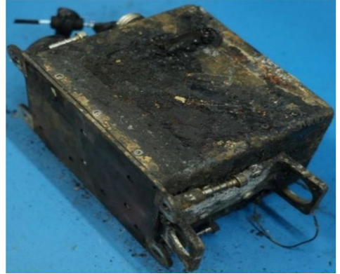
Die schwer beschädigten Flugdatenschreiber (EAFR). Links der hintere, rechts der vordere, der ausgelesen werden konnte. Quelle: AAIB
