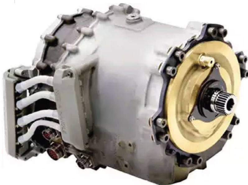
Ein 250 kVA Variable Frequency Starter Generator (VFSG) für die Boeing 787
