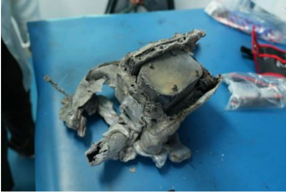
Die schwer beschädigten Flugdatenschreiber (EAFR). Links der hintere, rechts der vordere, der ausgelesen werden konnte. Quelle: AAIB
