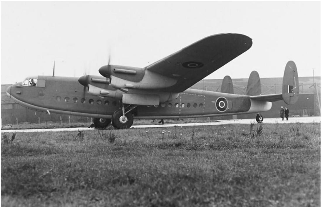
Das erste Foto einer Avro York (Erstflug 5. Juli 1942). Für dieses Transport- und Passagierflugzeug wurden Flügel und Leitwerk des Lancaster Bombers verwendet. Der geräumige Rumpf war eine Neuentwicklung. Das Flugzeug hatte vier Rolls-Royce Merlin Motoren mit je 1.280 PS. Die ersten zivilen Versionen gingen 1944 an die B.O.A.C. Imperial War Museum Duxford
