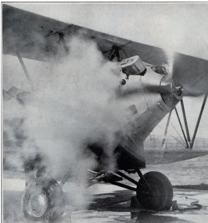
Das Besler Dampfflugzeug von 1933 brauchte keinen Runup. Im Flug und am Boden konnte Umkehrschub gegeben werden. Auch rückwärts Rollen war problemlos möglich... Popular Science Monthly - July 1933
