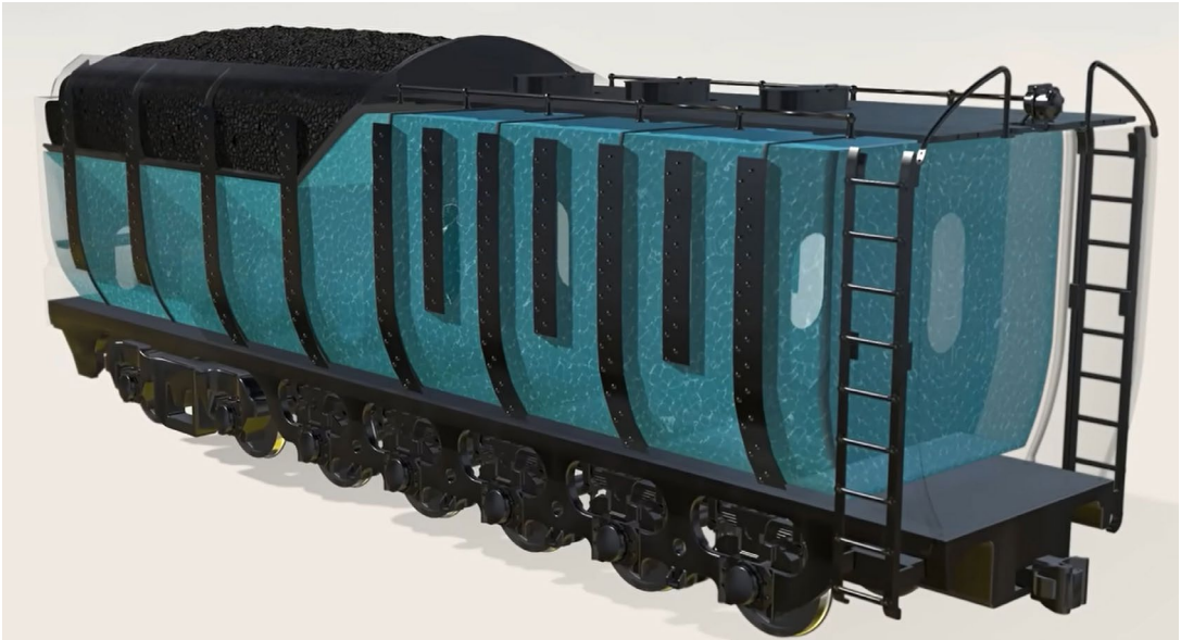
„Tanks“ des „Big Boy“ im Tender (oben) und Fire Box mit den Heiz- und Rauchrohren im „Big Boy“, vollständig umgeben vom wassergefüllten Dampfkessel (unten) aus [1]
