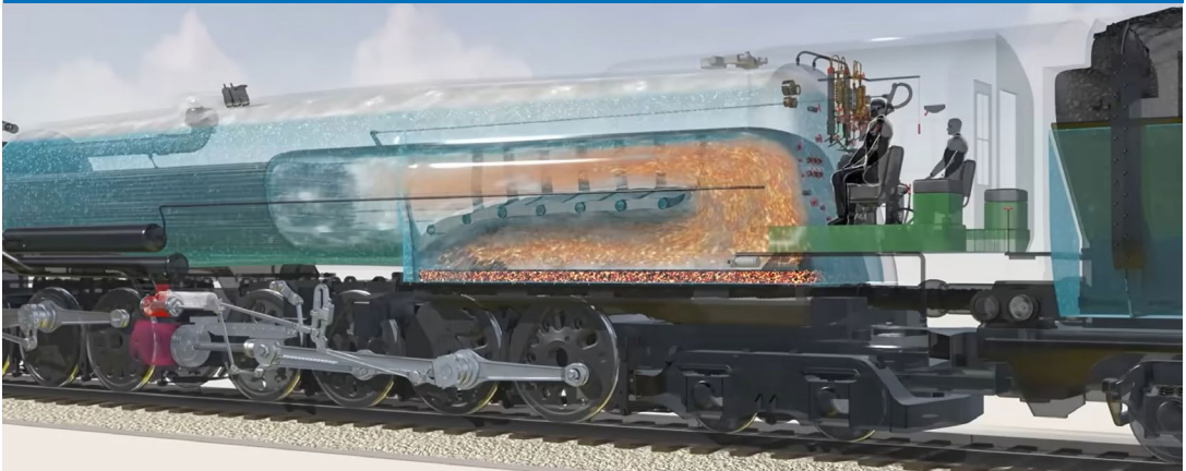
„Tanks“ des „Big Boy“ im Tender (oben) und Fire Box mit den Heiz- und Rauchrohren im „Big Boy“, vollständig umgeben vom wassergefüllten Dampfkessel (unten) aus [1]
