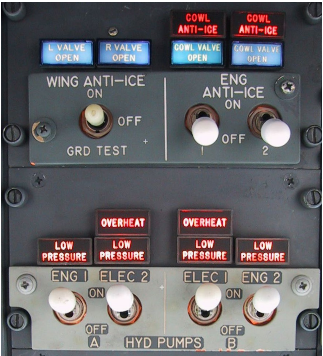
Die Lage der Engine Anti-Ice und der Hydraulik B Pumpen Switches im 737 Overhead Panel zur Illustration der COWL VALVE OPEN lights. Foto des Autors mit Light Test in einer Lufthansa Boeing 737. Bei Lufthansa wurden alle 737 Switches nach oben in ON gelegt, bei anderen Airlines genau andersherum. Auch bei Swiftair war die ON Position der Schalter unten.
