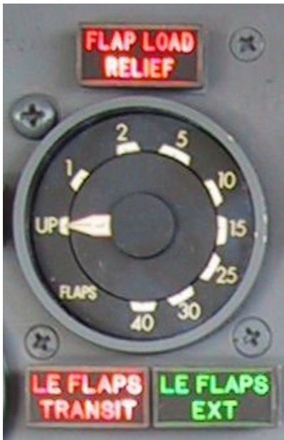
Klappen und Vorflügel (LE Flaps) Anzeige einer Boeing 737 mit Light Test. Bei dem Unglücksflug in Vilnius waren wahrscheinlich alle Lichter aus und die Anzeige bei „UP“ – un bemerkt von der Crew. Foto: Autor
