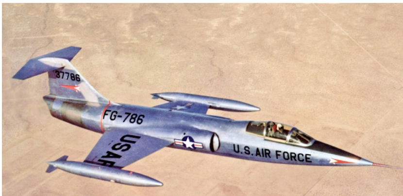
Der erste von zwei XF-104 Prototypen, mit abwerfbaren Tip-Tanks. Weil das neue General Electric J79 Triebwerk noch nicht fertig war, flogen die Prototypen mit dem schwächeren Wright J65 ohne Nachbrenner. Foto National Museum of the U.S. Air Force
