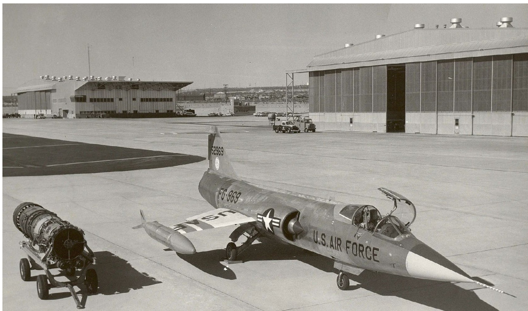
Ein Meisterwerk der Integration: Der Starfighter wurde um das leistungsstarke General Electric J79 Triebwerk mit Nachbrenner herumgebaut. Foto: U.S. Air Force
